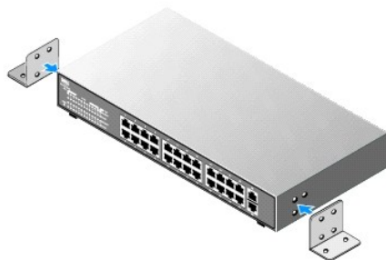
Рис. 1-8. Скобы для настенного монтажа
